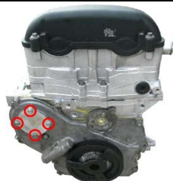
Fixer l'outil de retenue au moyen des 2 vis de l'outil de retenue sur la roue de la pompe et au moyen des deux vis originales du cache de la roue de pompe sur le revêtement frontal.
