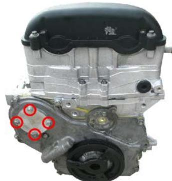
Fije la herramienta de retención a la rueda de la bomba con los 2 tornillos de la herramienta de retención y a la cubierta de la rueda de la bomba con los dos tornillos originales a la tapa frontal.
