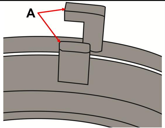
Coloque la herramienta de tensado (BGS 8284) en el embrague.
