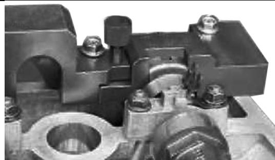
**Outil de réglage de l'arbre à cames d'échappement avec vis de raccordement**
