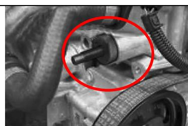
**Outil de fixation des roues d'encodeur**
