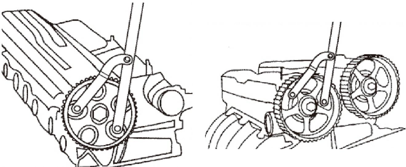
Beim Lösen bzw. Festziehen der Verschraubung muss das Gegenhaltewerkzeug entgegen der Drehrichtung der Verschraubung gedreht werden.
