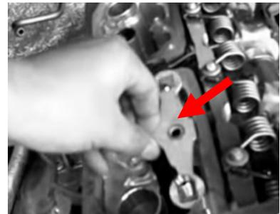
Schrauben vom Werkzeug im Gewinde der Halteblech-Verschraubung ansetzen.
