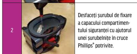
Desfaceți șurubul de fixare a capacului compartimentului siguranței cu ajutorul unei surubelnite în cruce Phillips® potrivite.
