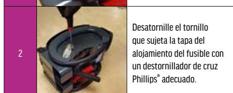
Desatornille el tornillo que sujetla la tapa del alojamiento del fusible con un destornillador de cruz Phillips® adecuado.
