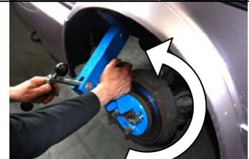
Vor jedem Drehrichtungswechsel die Vorspannung der Bördelrolle kontrollieren und ggf. mit dem Gleitgriff nachspannen.
